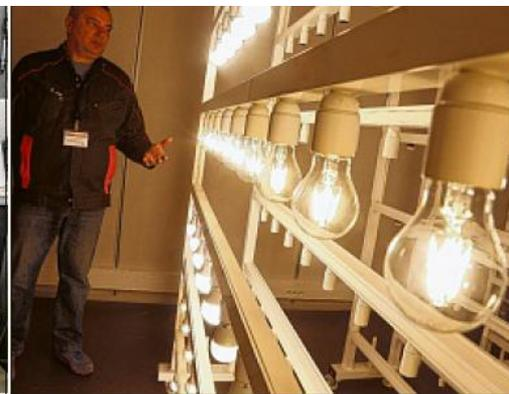
Les poussettes sont mises à dure épreuve sur un banc d'essai. Là, on analyse la qualité des détergents utilisés dans les toilettes. Ici, on étudie le vieillissement des lampes LED et ensuite, on mesure leur puissance et durabilité.
