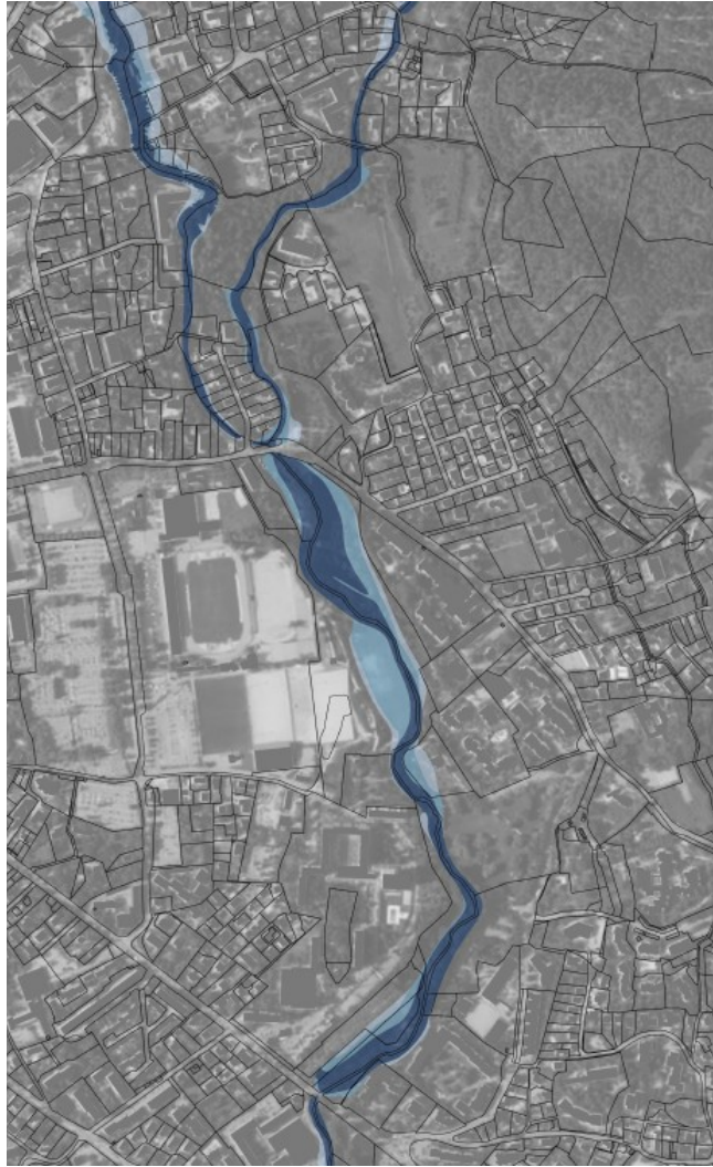
Figure 34 : Extrait de la carte des hauteurs d'eau pour la crue de référence (source : Étude hydraulique, SAFEGE-HORIZON – Aix-en-Provence, 1997)
