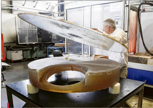
Pour être transformés en miroir, les énormes blocs de verre sont usinés jusqu'à perdre 80 à 90% de leur masse. Leur production est vendue dans le monde entier. /PHOTOS CYRIL SOLLIER
