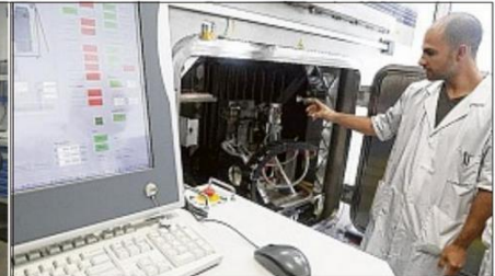
Le site doit s'agrandir pour acquérir plus de machines. Ce savoir-faire de haute technicité demande une salle blanche et des outils pour un polissage précis (ici la machine IBF-1500R).
